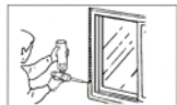
●コンクリートとアルミ窓枠、ドア枠の接着・すき間充てん・結露防止。
